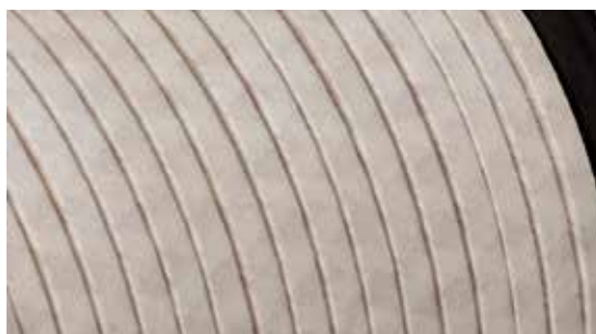
扁铜线由两层SynTherm® YT510绕包绝缘，方向相反，30%重叠
