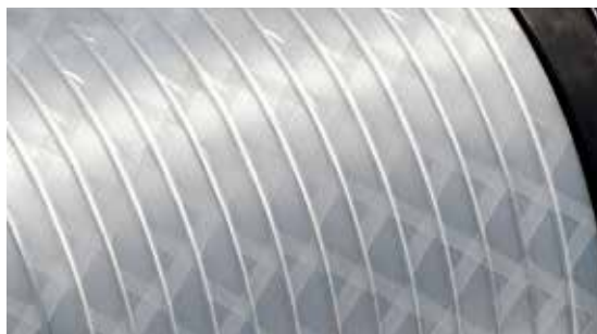
扁铝线由两层SynTherm® P绕包绝缘，方向相反，20%重叠
